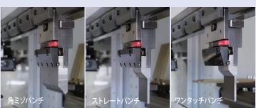
◆アマダ仕様のワンタッチ・角ミゾ付・ストレートタイプの パンチすべてが、**レバー操作一つ**でクランプできます。
