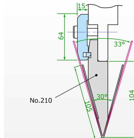
30度鋭角曲げをすると、加工ワークがマルチクランプ金具へ干渉します。干渉したまま曲げると、加工製品にキズや精度不良をおこす原因となりますので、干渉しない範囲でご使用ください。
