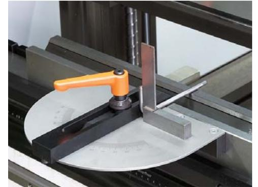
丸棒曲げの加工例 広いテーブルに直角スコヤーを使用して丸棒2ヶ所の正確な並行曲げ
